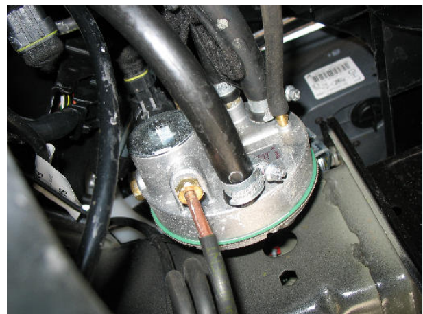
podłączenie reduktora. Wszystkie węże gumowe należy zamocować na króćcach za pomocą metalowych opasek zaciskowych
