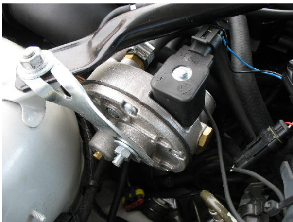
wspornik reduktora, podłączenie elektryczne zaworu odcinającego
